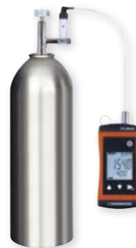
Kalibrierung an Prüfgas
