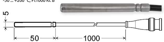
V4A-Fühlerhülse Ø 5 mm, 1 m hochflexibles Silikonkabel, BNC-Stecker, 1 m
