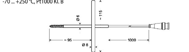
zum Einschrauben in Gefriergut, etc. ohne vorheriges Vorbohren, V4A-Rohr Ø 6
