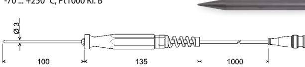
V4A-Rohr Ø 3 mm mit nadelförmiger Einstechspitze, Kunststoffhandgriff, Knick-
