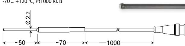
Stirnseitiges Pt1000-Keramikplättchen 2 x 2,3 mm, V4A-Rohr Ø 2,2 mm, 1 m
