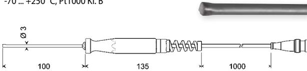
Stirnseitiges Pt1000-Keramikplättchen 2 x 2,3 mm, V4A-Fühlerrohr vorne 3 x
