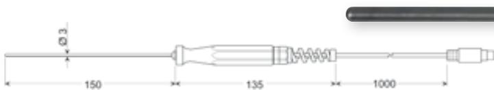
rostbeständiges V4A-Rohr Ø 3 mm, Kunststoffhandgriff, Knickschutzverschraubung, ca. 1 m 4-pol. PVC-Kabel, 4-pol. Mini-DIN-Stecker
