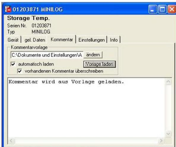
Sobald Loggerdaten ausgelesen worden sind, können hier beliebige Kommentare eingegeben werden. Beim Ausdruck von Tabellen kann dieser Kommentar dann mit ausgedruckt werden. Werden die Loggerdaten in einer Datei gespeichert, wird der Kommentar mit abgespeichert.
