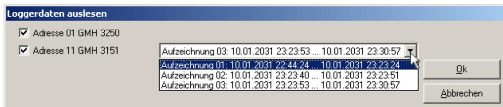
Um die Logger auslesen zu können, müssen Sie bei zyklischer Aufzeichnung zunächst gestoppt werden. D.h. um einen zyklischen Logger auslesen zu können müssen Sie die Aufzeichnung unterbrechen! Das Programm gibt in diesem Falle die entsprechenden Anweisungen.
