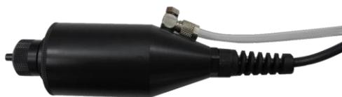
Die GOG / ResOx Gehäuse stellen ein Gasprobenahmevorrichtung dar, die in Verbindung mit einer Gaspumpe geeignet sind gezielt kleine Gasproben zu nehmen und zu analysieren.
