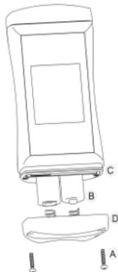
1. Die Kreuzschlitzschrauben (A) herausschrauben und den Deckel abziehen.
