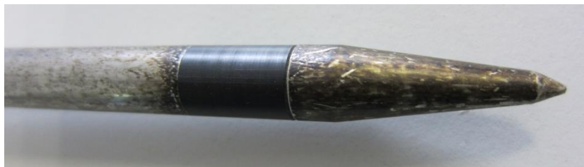
Verunreinigte Elektrodenspitze -> misst falsch!
