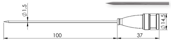
Einstechspitze Ø 1,5 mm aus V4A-Rohr, IP67 im gesteckten Zustand, BNC-Stecker mit EPDM Tülle bis +75 °C
