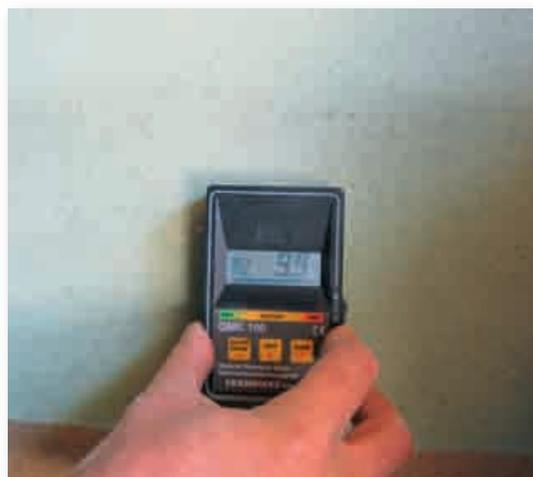
Prinzipiell gibt es eine große Bandbreite an angebotenen Feuchtemessgeräten - in allen Preisklassen - mit unterschiedlichen Messverfahren. Deshalb gilt es, anhand der Immobilienart und der zu begutachtenden Schäden eine Vorauswahl zu treffen. Mögliche Messverfahren sind Widerstands- und Kapazitätsmessverfahren sowie indirekte Verfahren und Infrarot- und Mikrowellenverfahren.
