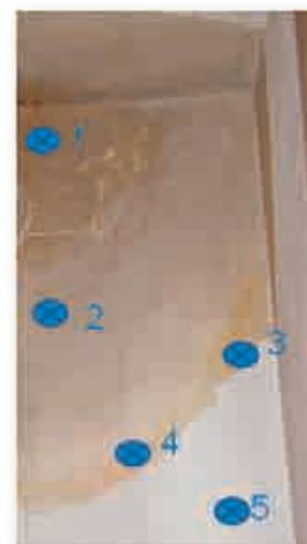
Die Werte, die bei diesen Messpunkten ermittelt werden, sind um den Trocknungsfortschritt zu erkennen, z.B. wöchentlich zu protokollieren. Generell sind beim GMK 100 zwei Messtiefen von 10 mm und 25 mm einstellbar, so kann man beurteilen, ob das Material bereits abgetrocknet ist oder es sich um Oberflächenfeuchte handelt.
