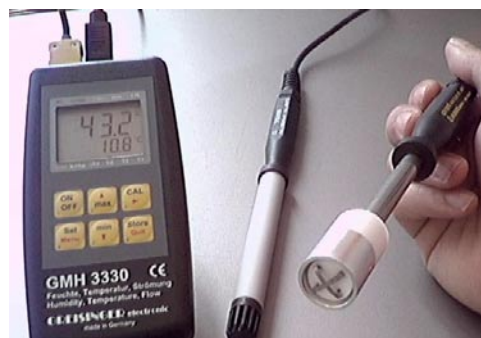
GMH3330: Profifgerät mit Raumfühler TFS0100 und Oberflächenfühler GOF130VE
