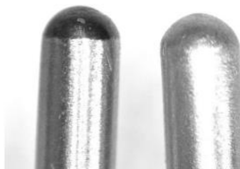
Links: Fühlerrohr mit Oxid-Schicht
