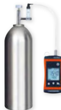
Kalibrierung an Prüfgas
