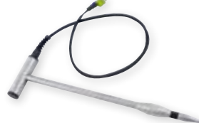
GSF 50TF (110 cm) Art.-Nr. 601312 GSF 50TFK (43 cm) Art.-Nr. 601313 Einstechfühler, mit Temperatursensor zur Messung in Messtiefen bis 40 cm bzw. 107 cm, inkl. 1 m Anschlusskabel. Geeignet für: Hackschnitzel, Holzwolle, Holzspäne, Stroh, Heu, Getreide, Sägemehl, etc.
