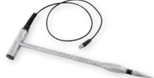
GSF 50 (110 cm) Art.-Nr. 601306 GSF 50K (43 cm) Art.-Nr. 601308 Einstechfühler, (ohne Temperatursensor) zur Messung in Messtiefen bis 40 cm bzw. 107 cm, inkl. 1 m Anschlusskabel. Geeignet für: Hackschnitzel, Holzwolle, Holzspäne, Stroh, Heu, Getreide, Sägemehl, etc.
