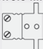
NKU 1200 O Kupplung mit Ohren für Gehäuseeinbau
