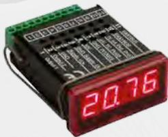
Als universelles Anzeige- oder Regelgerät innerhalb des EASYBus-Systems einsetzbar!
