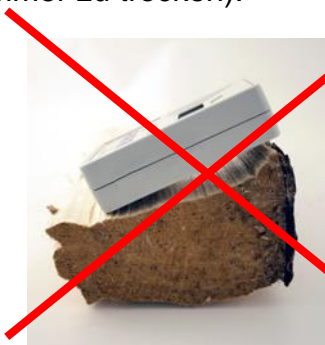
Falsch: Verworfene Oberfläche (hier extrem!)
