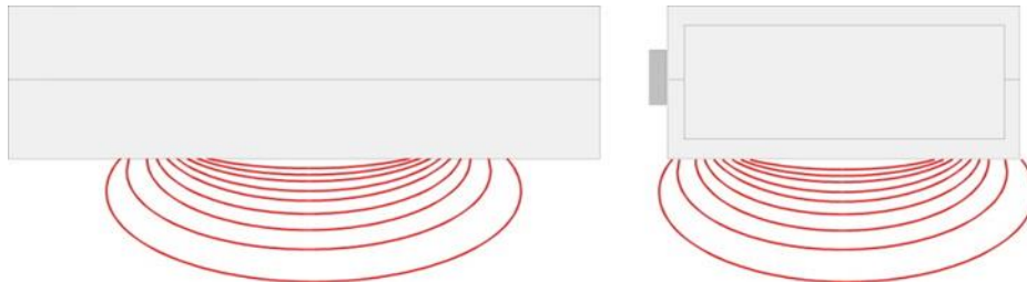
Seitenansicht: Messfeld und Eindringtiefe ca. 25 mm
