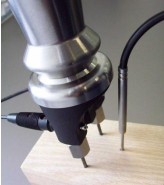
Hohlhammerlektrode GHE91 mit Temperaturfühler GTF38
