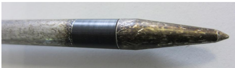
Verunreinigte Elektrodenspitze -> misst falsch!
