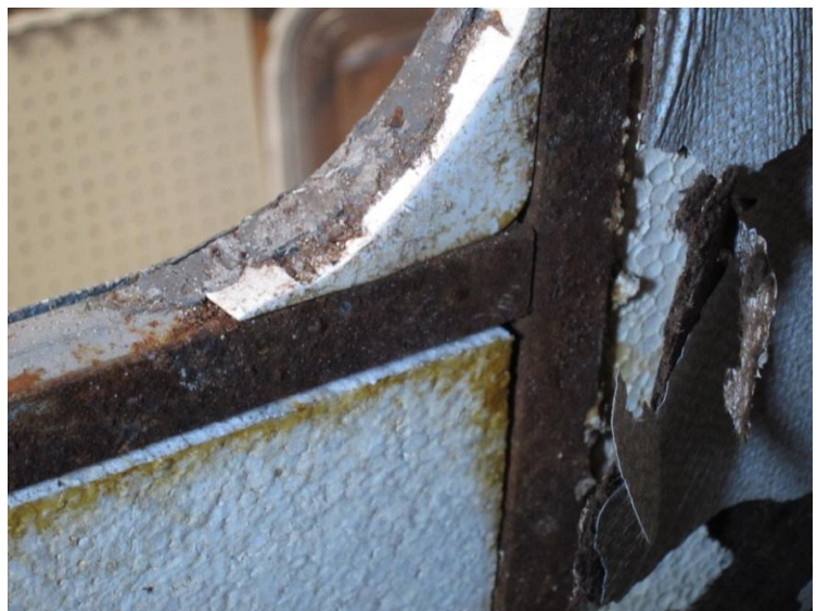
Isolation und Metallrahmen an älterem Wohnwagen
