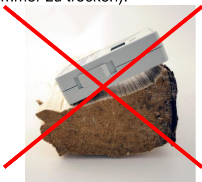
Falsch: Verworfene Oberfläche (hier extrem!)
