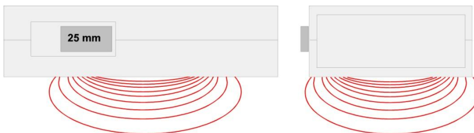
Seitenansicht: Messfeld und Eindringtiefe bei Schalterstellung „25 mm“
