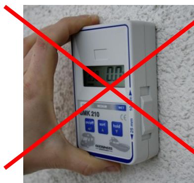
Falsch: unregelmäßige Oberfläche
