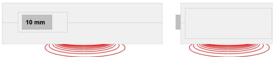
Seitenansicht: Messfeld und Eindringtiefe bei Schalterstellung „10 mm“
